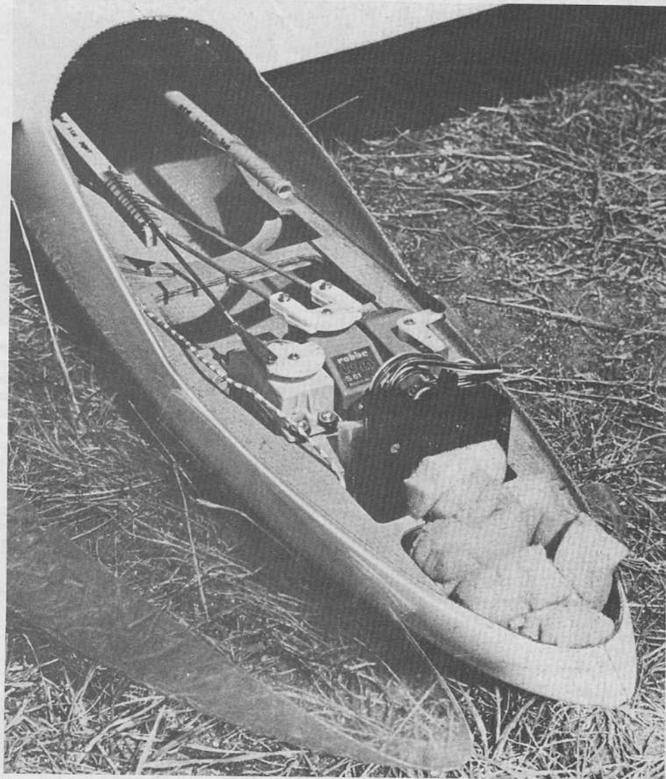
La radio trouve sans problème sa place dans le large fuseau du Silène et la verrière tient avec du scotch.
