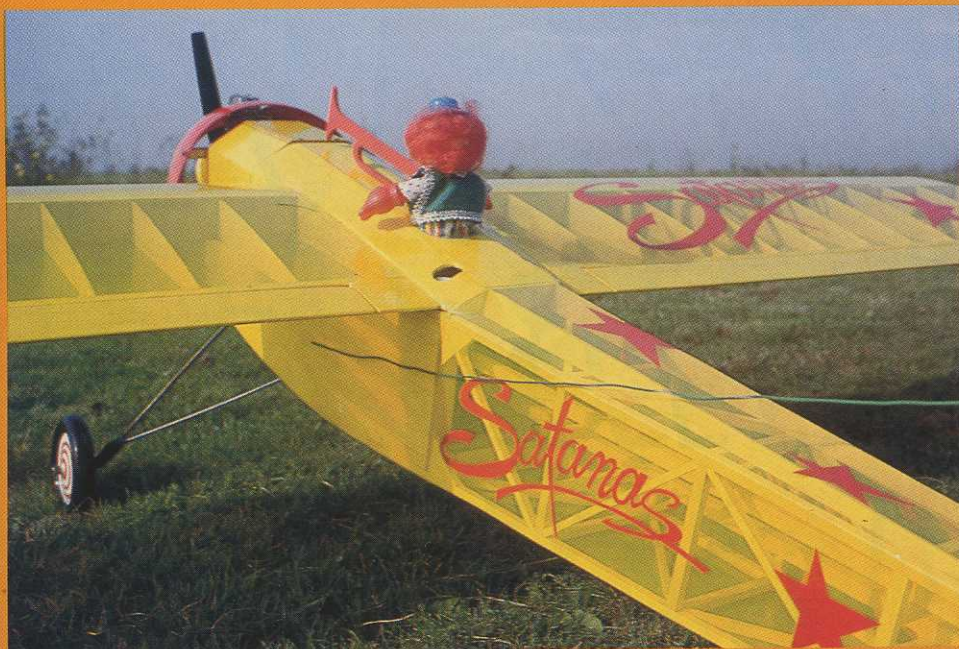
L'un des plus beaux Satanas construit à l'occasion de cette présentation. L'entoilage transparent permet d'apprécier la structure, très simple au demeurant.
