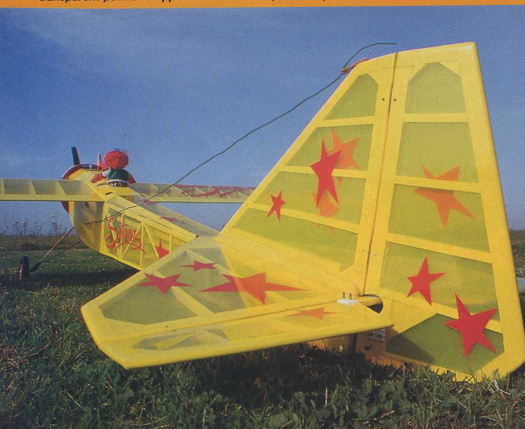
L'un des plus beaux Satanas construit à l'occasion de cette présentation. L'entoilage transparent permet d'apprécier la structure, très simple au demeurant.
