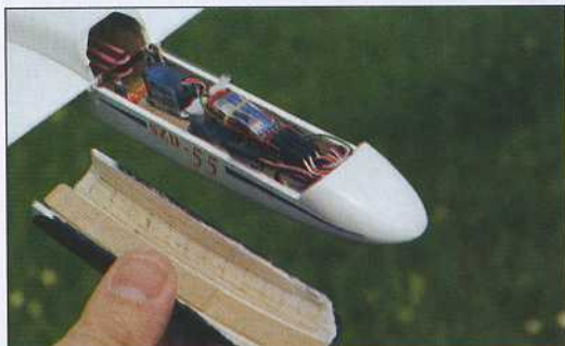
Gros plan sur l'installation radio qui réclame impérativement du matériel au format du planeur, c'est-à-dire micro.
