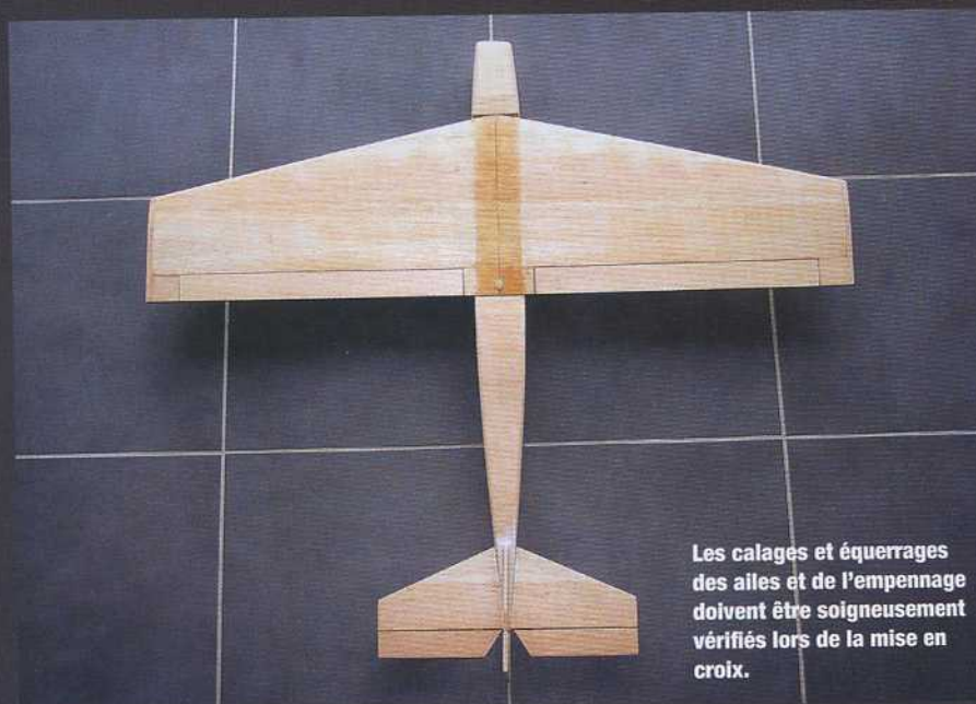
Une bande en tissu de verre 80 à 100g/m 2 + résine époxy lente renforce la partie centrale, l'aile à ce stade, pèse 220g.
