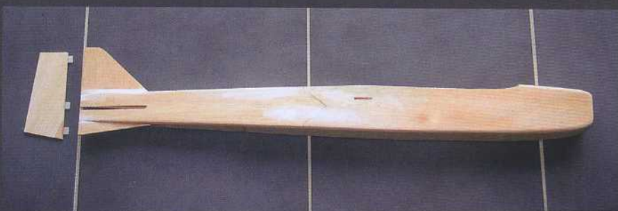
Le fuselage terminé pèse 250g sur la balance ; le choix du bois peut faire sensiblement varier cette valeur.
