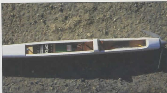
Installation radio de la version électrique.
