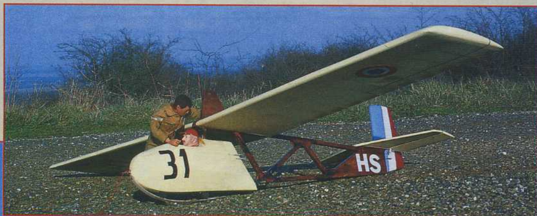
Posé sur son patin amorti, ce SG 38 n'attend qu'un peu de vent pour évoluer à la pente. Notez les commandes par câbles qui sortent des flancs de la partie fermée du fuselage.
