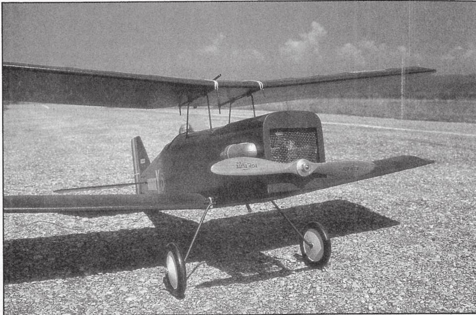
Voilà la première version du capot maquette. On voit par en-dessous l'installation simple du moteur monté droit.
