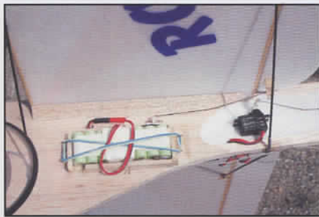
L'accu est fixé par des élastiques sur Rolph, pour un remplacement rapide.
