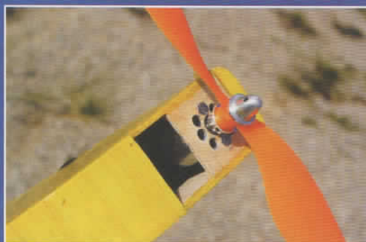
Le Flyware Rex 220 est bien ventilé dans le nez d'Achille (qui n'est bizarrement pas rouge...).
