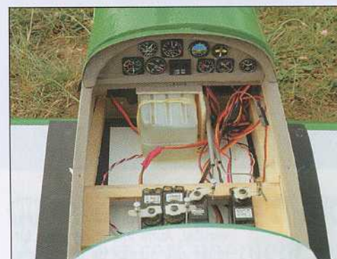
On nage dans le bonheur pour installer la réception à bord de ce généreux fuselage, malgré la présence du réservoir qui, volumineux, empiète sur le compartiment radio de la cabine.
