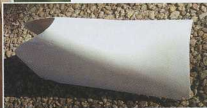
Gros plan sur le montage particulier du stabilisateur pendulaire dont la commande est intégrée dans le fuselage. Le pied de dérive est ensuite caréné par une petite pièce (détail ci-contre) réalisée par la méthode du moule perdu.
