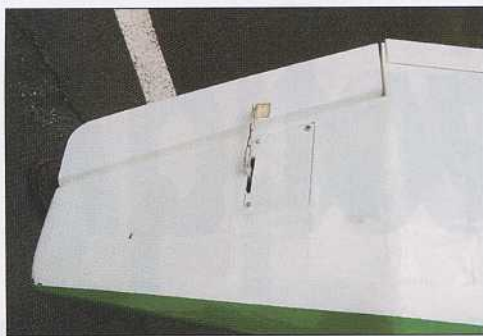
Chaque aileron est actionné en attaque directe par un servo de format standard. Simple !
