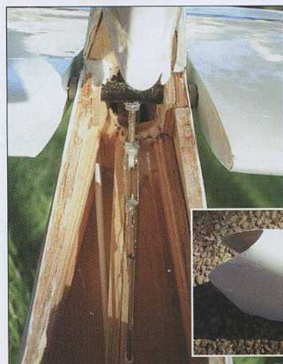
Gros plan sur le montage particulier du stabilisateur pendulaire dont la commande est intégrée dans le fuselage. Le pied de dérive est ensuite caréné par une petite pièce (détail ci-contre) réalisée par la méthode du moule perdu.
