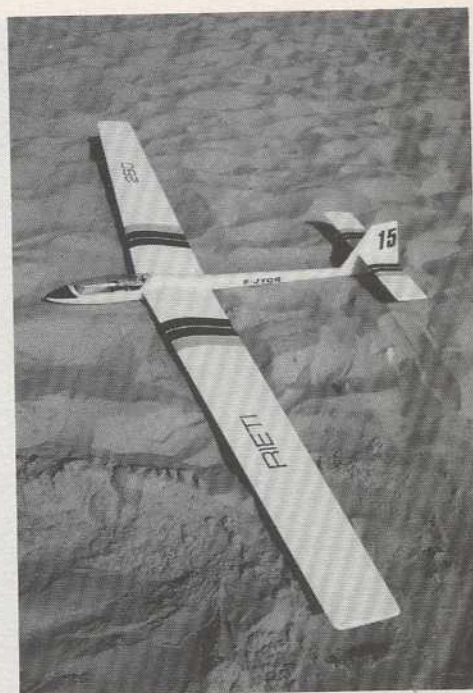
Le bord de fuite est rectiligne. Toute la flèche est donnée au bord d'attaque.
