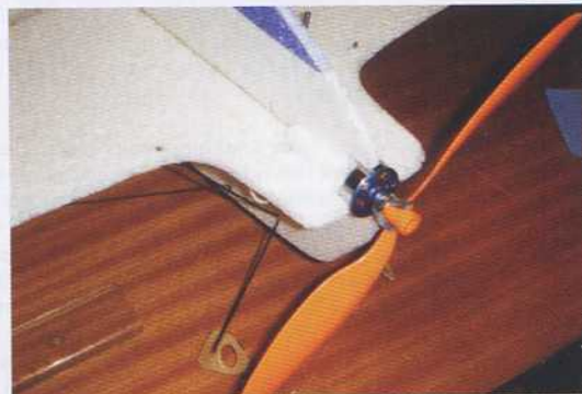
Montage encastré d'un moteur chinois.
