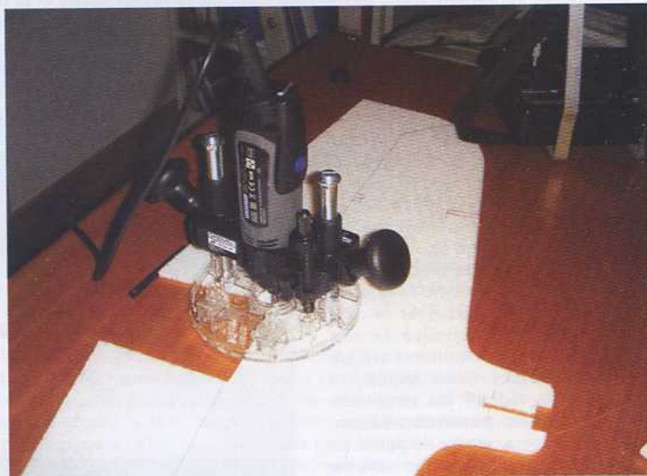
Découpe des charnières dans l'EPP avec une Dremel utilisée en défonceuse.
