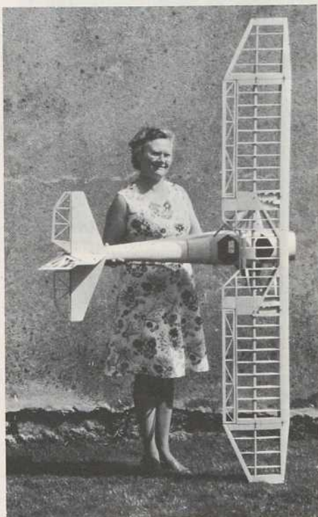
Deux vues de la structure avant entoilage qui permettent d'apprécier le respect de la structure par rapport au vrai.
