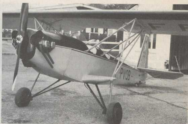
Cette vue permet de voir les découpes du capot moteur.
