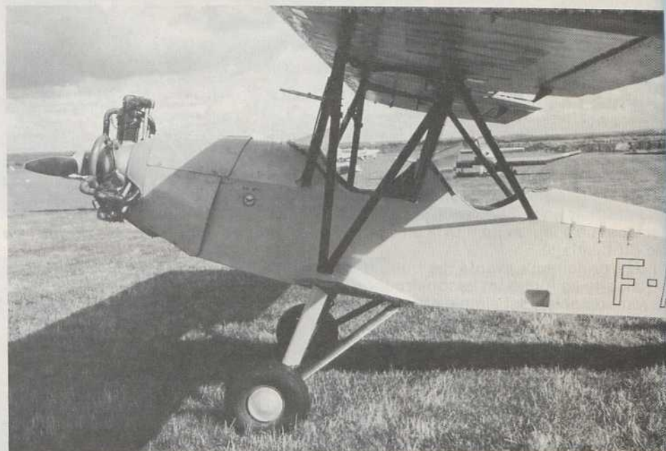
Vue latérale du Potez de M. Chevassut, permettant d'apprécier les formes exactes de la cabane.
