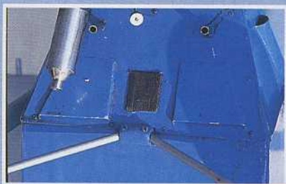
Sous le fuselage, derrière le moteur sont placées des ouïes de refroidissement.
