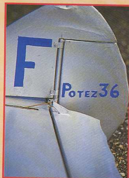
Détail des empennages. Le câble de la commande de profondeur traverse la partie fixe du stabilisateur.
