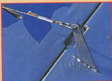
La commande par câble aller et retour des ailerons fut une véritable partie de plaisir à réaliser.
