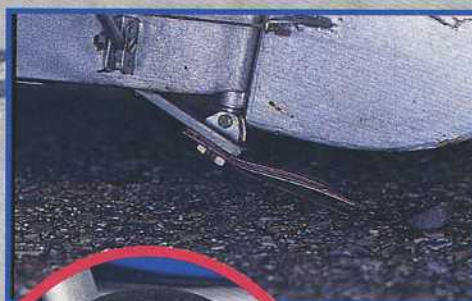
Détail de la béquille fixe de queue, fabriquée avec des lames de ressort.
