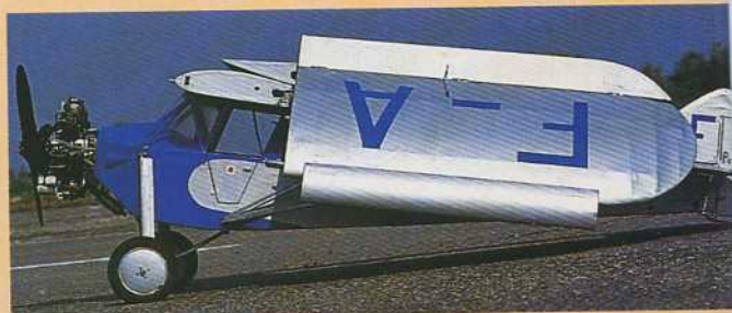
Attention de bien verrouiller l'aile en position ouverte avant le vol.
