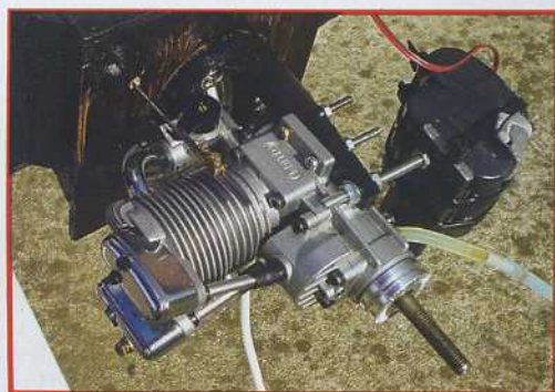
Le saïto FA 56 4 temps tient intégralement à l'intérieur du volumineux capot...
