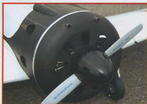
... capot qui est d'ailleurs, sur le prototype, entièrement réalisé en bois...
