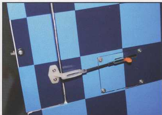
La commande directe d'aileron. Noter le parfait raccord du décor à carreaux entre la trappe et l'aile.
