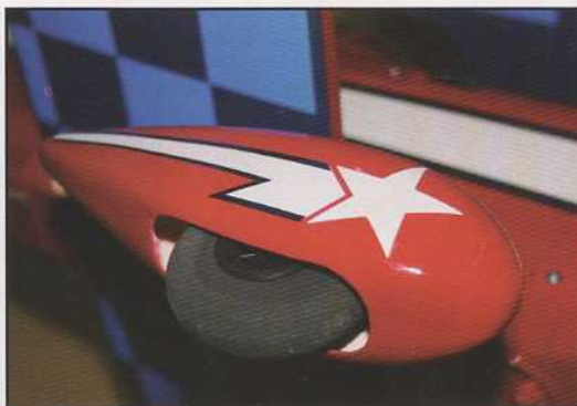
Les caches roues, (et le capot moteur), sont en fibre de verre peinte, de très belle facture.
