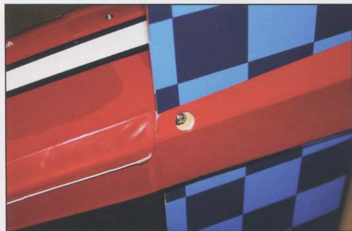
Le capot inférieur en bois se fixe avec l'aile, assurant une jonction impeccable. L'antenne de réception est protégée par une fine durit silicone à sa sortie du fuselage.
