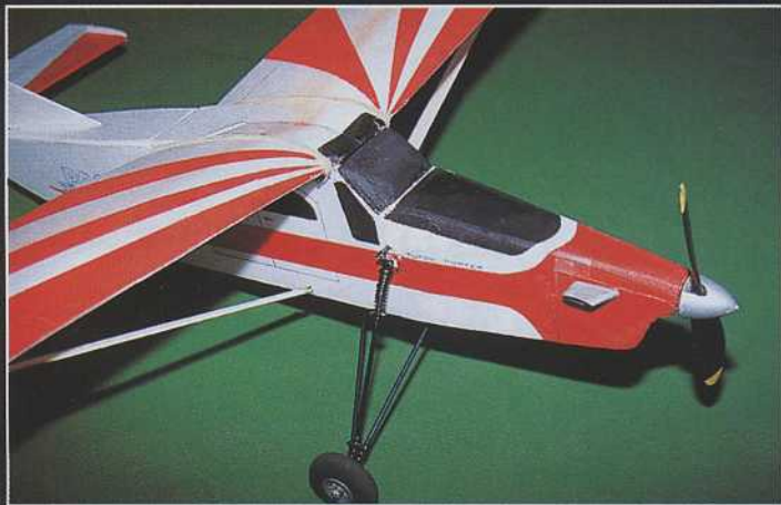
La version le plus évoluée, avec le train amorti en tube carbone.
