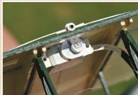
Les ailerons sont commandés par un servo central, positionné au bord d'attaque de l'aile.
