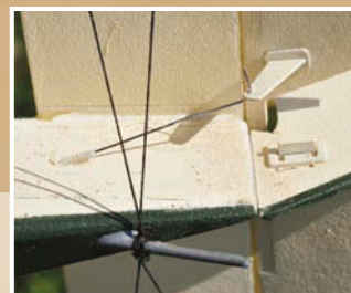
Le haubannage du stab est nécessaire.
