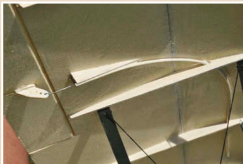
Le profil "planche creusée" de l'aile et la commande d'aileron.
