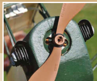
Discret, le moteur électrique, au milieu des faux cylindres.
