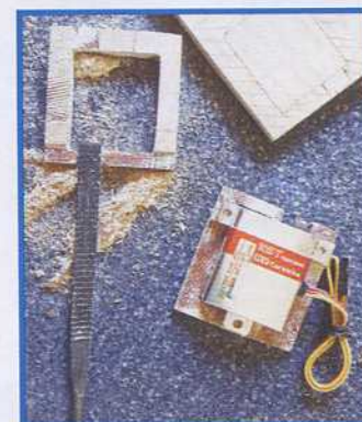
L'auteur n'a pas utilisé des baignoires de servo du commerce, mais a réalisé les siennes "à la main" dans du contre-plaqué
