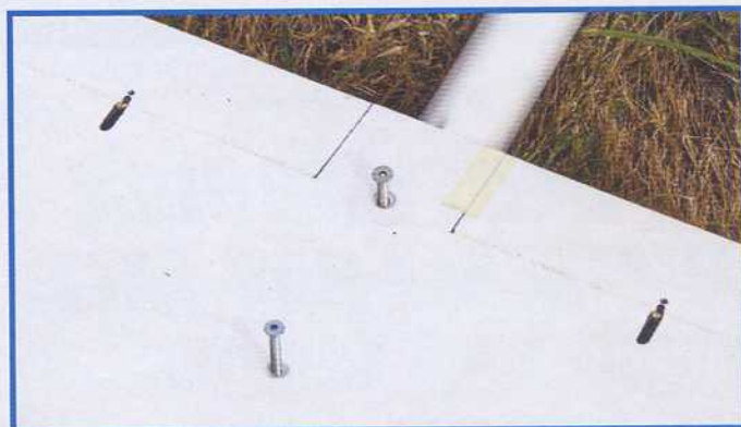
Vis de fixation du plan d'aile central... remarquez les guignols de commande des volets déjà posés.
