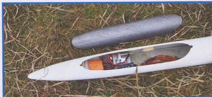
Evidemment, vu que le servo de profondeur est à l'arrière, la place ne manque pas à l'avant...
