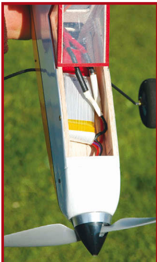
Le logement de l'accu est surdimensionné pour des Lipos !
