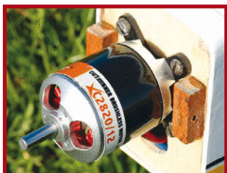
Le moteur XPower 2820/12, directement fixé sur le couple "pare-feu".
