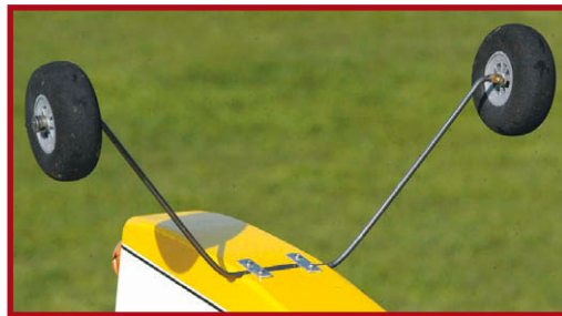
Le train, composé de deux jambes décalées, est maintenu en place par deux cavaliers.
