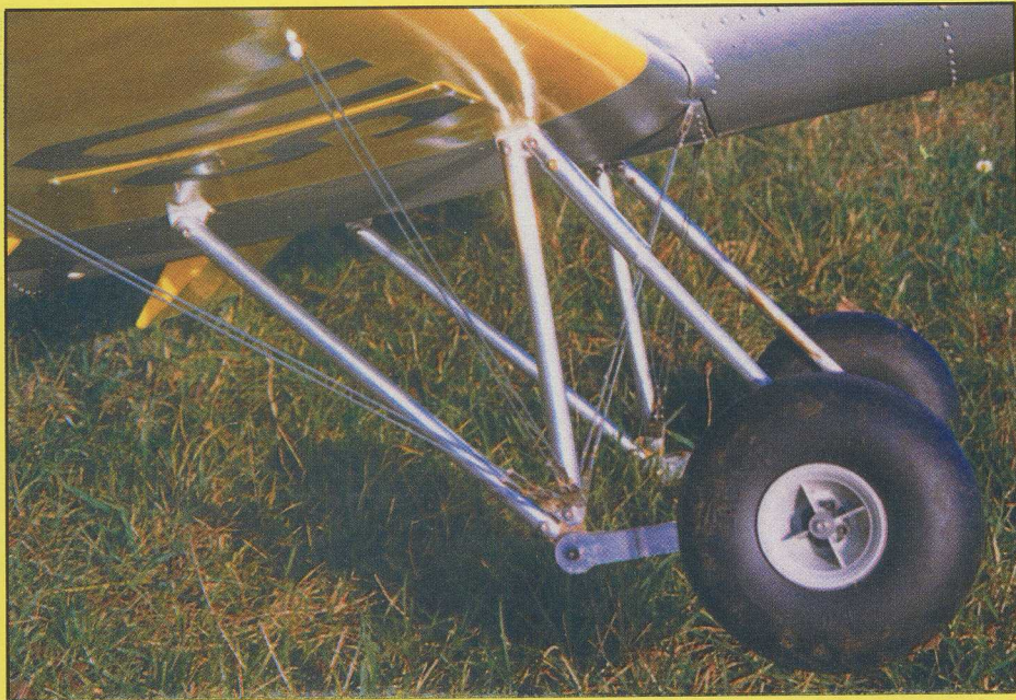
Cette vue du train montre bien les fixations des haubans sur les jambes. Les pièces du train sont usinées dans du dural ; l'ensemble est haubanné par du câble vélo, de 12/10.
