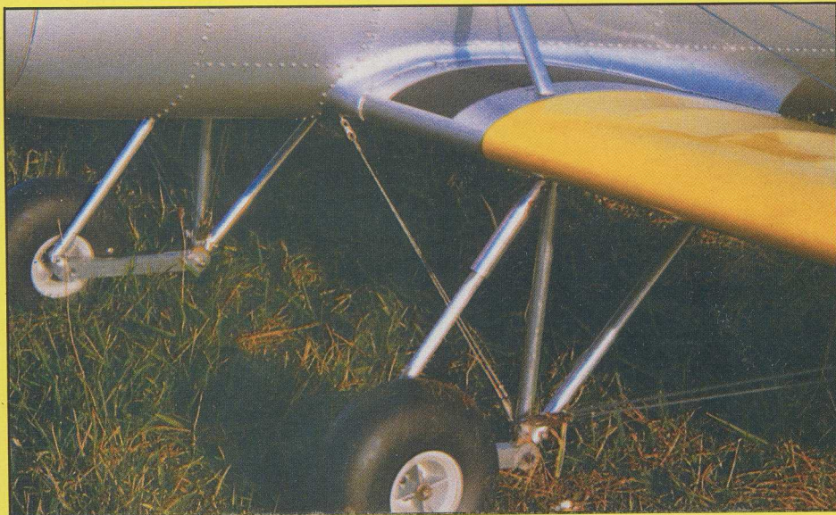
Cette vue du train montre bien les fixations des haubans sur les jambes. Les pièces du train sont usinées dans du dural ; l'ensemble est haubanné par du câble vélo, de 12/10.
