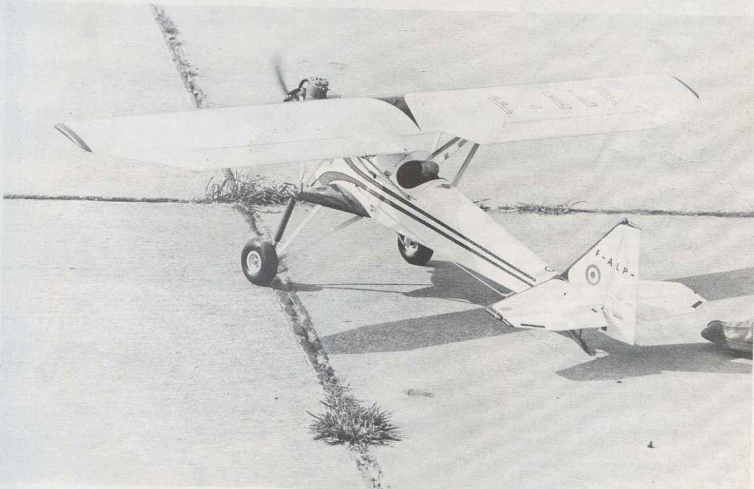
Ci-dessus, le Potez 60 attend, moteur au ralenti. Ci-contre, le Potez 60 fait un premier passage au-dessus de la piste à mi-gaz. La stabilité est bonne mais la vitesse de vol est encore importante.
