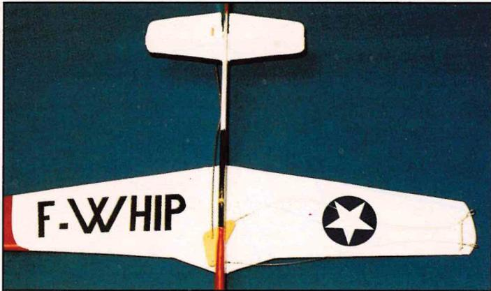
**Vu du dessus : on voit parfaitement l'ensemble de la commande de profondeur.**
