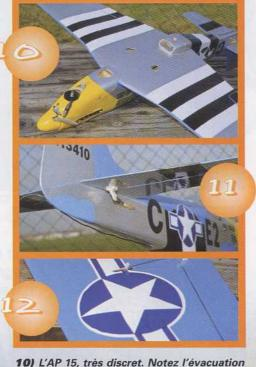
d'air chaud au bord d'attaque et les orifices à l'intrados pour la préhension du modèle au lancé. 11) La transmission de profondeur, directe. L'antenne court sous le fuselage, protégée au sol par l'entrée d'air. 12) Les commandes d'ailerons prennent place à l'extrados pour les protéger lors des atterrissages. Appréciez la fidélité des formes.
