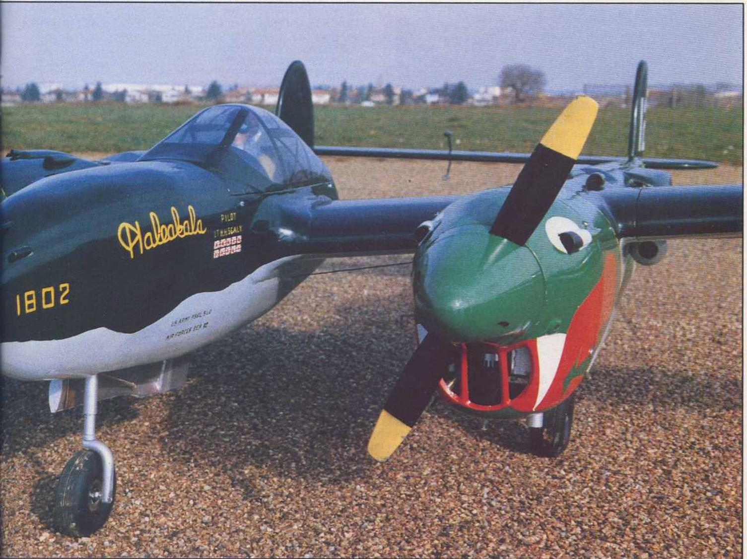
teur de la même époque dont l'envergure est de 10 à 12 mètres, et la surface de 19 à 22 m<sup>2</sup>. La maquette a donc peu de surface alaire, par rapport à un monomoteur de même envergure. Ceci m'a amené à tricher légèrement, 2 cm, sur la corde marginale et à allonger les saumons de 15 mm. De la sorte, au lieu d'obtenir 54 dm<sup>2</sup>, je suis à 56,5 dm<sup>2</sup> ; l'échelle générale est 1/75.
