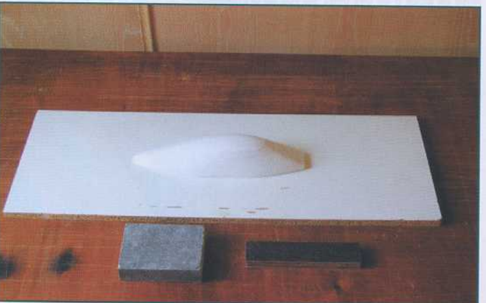
Réalisation de la forme du cockpit en Depron, puis stratification tissu 2 \times 160 g + 1 \times 80 g et résine époxy mais il existe tout fait chez SIG, voir carnet d'adresses.
