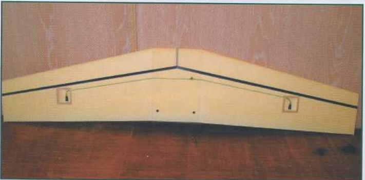
Les rallonges en place avant pose d'une baguette balsa 1,5 x 3 mm de fermeture de la saignée. Les prises sont piquées dans le styro avant stratification.
