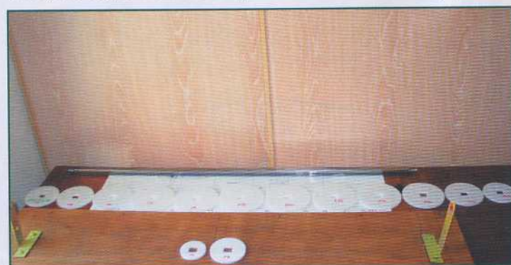
Préparation des couples en Depron de 6 mm.
