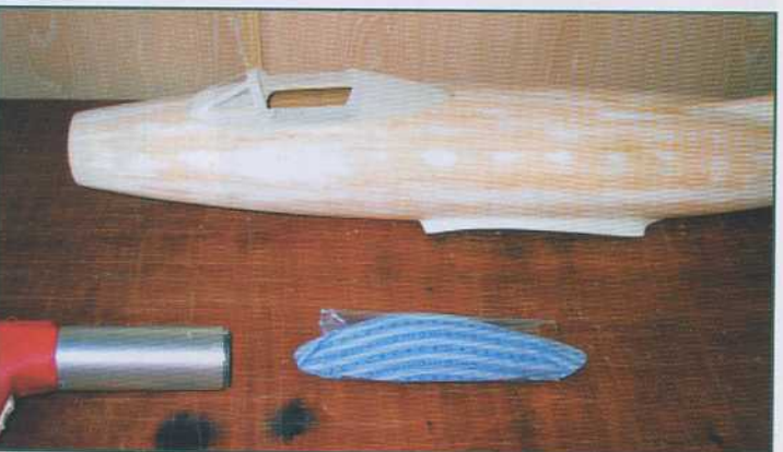
Thermoformage de la partie non développable sur la forme en Depron protégée de la chaleur par un tissu extensible puis découpe des vitrages en PVC. En haut de la photo, on notera le cockpit détourné à la miniperceuse.
