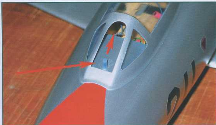
Entrée d'air suffisante et ventilation sont obtenues en déposant le vitrage avant. Une Durit sur le jonc carbone maintient le cockpit en place mais des aimants sont aussi proposés sur le plan.
