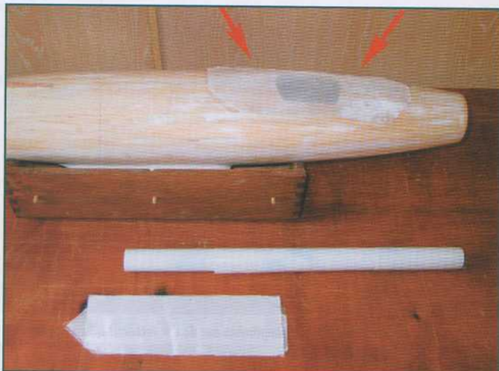
La base du cockpit est stratifiée avec trois couches de tissu 80 g/m 2 sur le fuselage protégé par du film adhésif transparent de protection de cahier.
