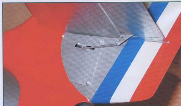
Profondeur et ailerons sont équipés de commandes directes en corde à piano 15/10 cousée aux extrémités, sans chape de fiabilité..
