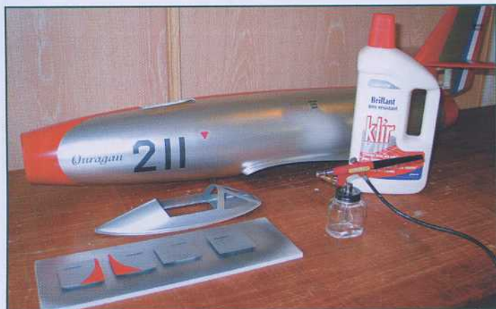
Un vernis acrylique d'excellente qualité disponible en grande surface, du Klir Johnson bien connu des maquetistes plastique, est appliqué à l'aérographe pour protéger la finition aluminium.
