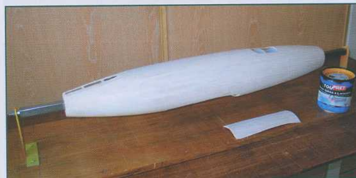
Application d'un enduit à laquer puis ponçage à l'eau grain 280 puis 400.
