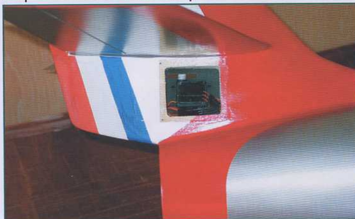
Mise en place d'un des deux servos de profondeur.
