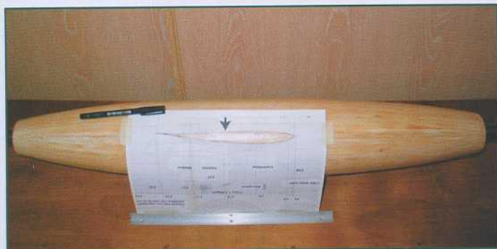
Traçage puis découpe de l'assise de l'aile, tenir compte du calage positif de +1,0^\circ .
