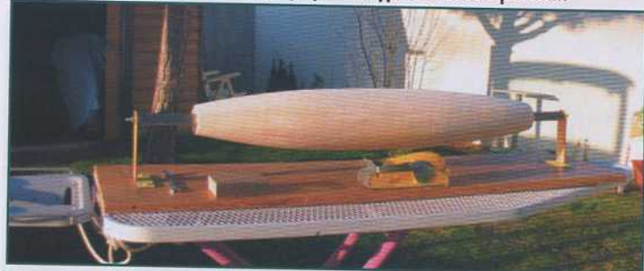
Ponçage en extérieur avec une lumière rasante pour éviter les creux ou facettes.
