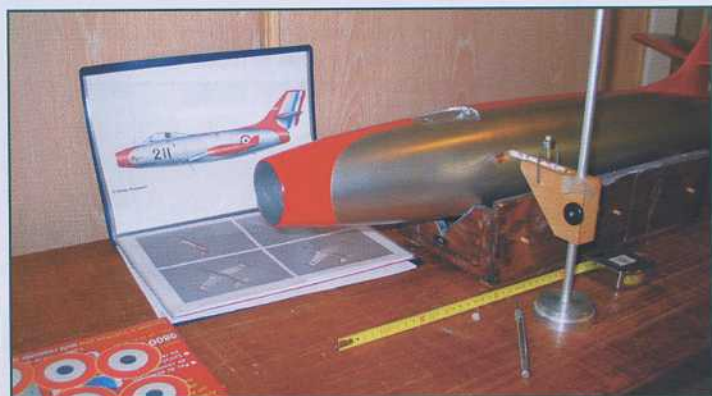
Un trusquin, voir MRA 778, assure une pose rigoureuse des décorations, immatriculations et marquages.
