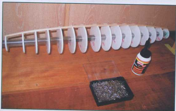
Un point de colle blanche rapide et une épingle fixent les baguettes. Un filet de cynao fluide dans les zones situées entre les couplets, solidarise les baguettes.
