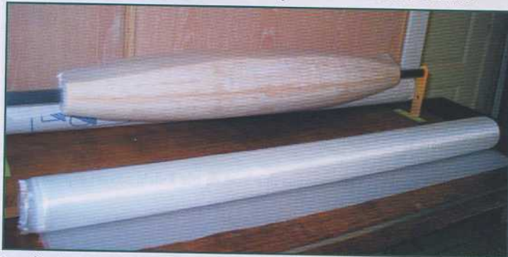
Stratification tissu 80 g/m 2 , doublé sur le dessous et résine époxy appliquée dans un local ventilé.
