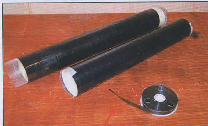
Une bande magnétique de cassette VHS sert de moule extérieur et élimine le surplus de résine.
