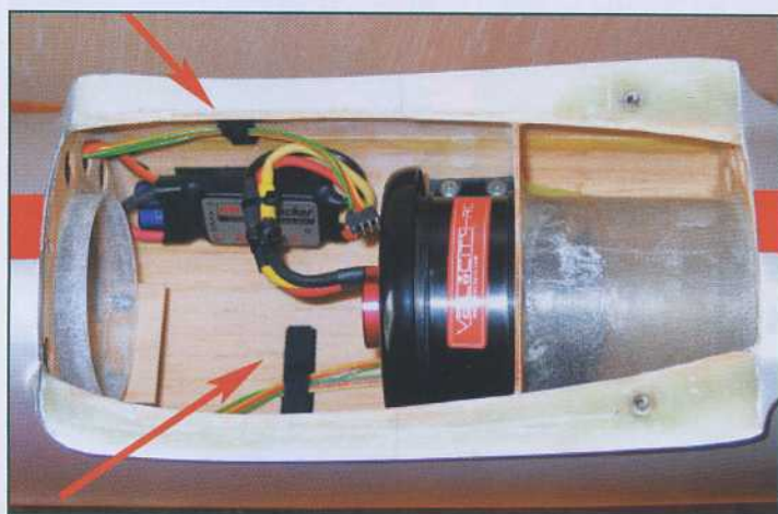
Installation de la turbine Velocity et du contrôleur, les fils radios sont maintenus par des bandes Velcro sur la paroi du fuselage.
