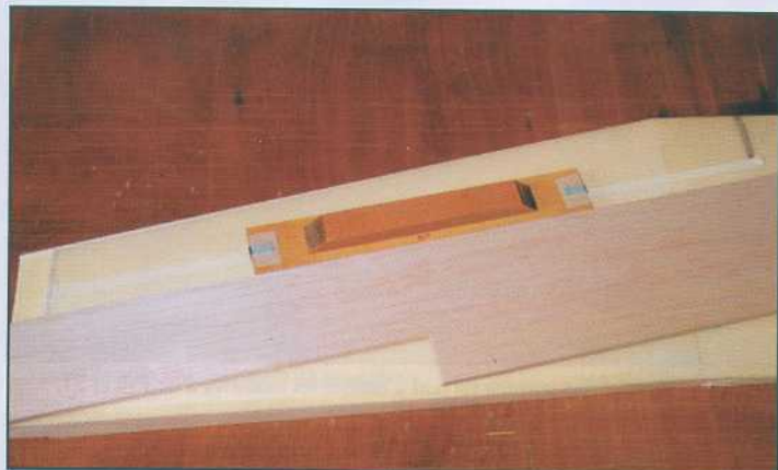
Ponçage du logement des longerons contre une planche en balsa pour ne pas marquer les noyaux.
