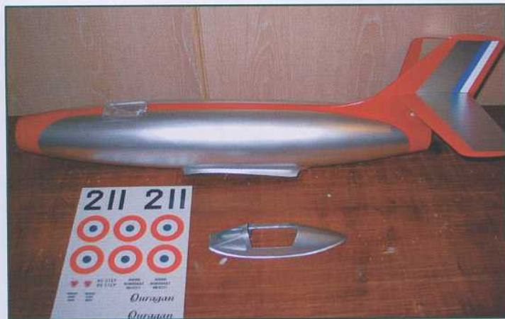
Les décorations dessinées sur PC sont imprimées sur de l'autocollant Micro Application transparent ou blanc pour les cocardes.
