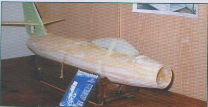
Collage à l'Araldite du cockpit sur la base stratifiée, après avoir percé deux trous de 2 mm pour centrage ultérieur avec du jonc carbone.
