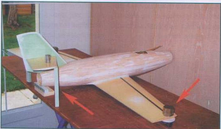
Mise en croix avec poids et baguettes de stabilisation, stabilo calé à +0,2^\circ , pendant la prise de la résine époxy chargée de fibre broyée.
