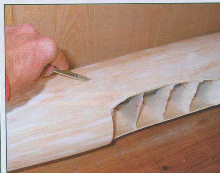
Séparation des demi-coquilles avec une fine lame de scie X-Acto suivant le passage 4/10 prévu au début du travail.
