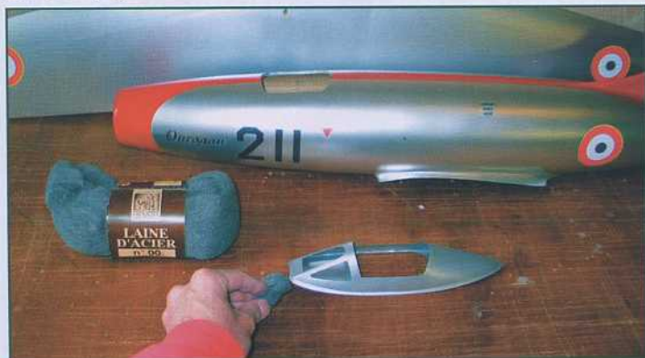
De la laine d'acier 00 d'ébéniste permet de vieillir, par de fines rayures dans le sens du vol, l'état de surface.
