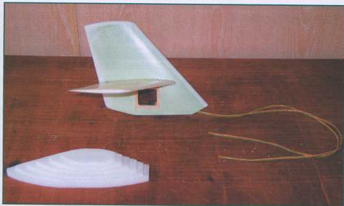
Passage des fils servos dans la dérive et bloc pour le cockpit.
