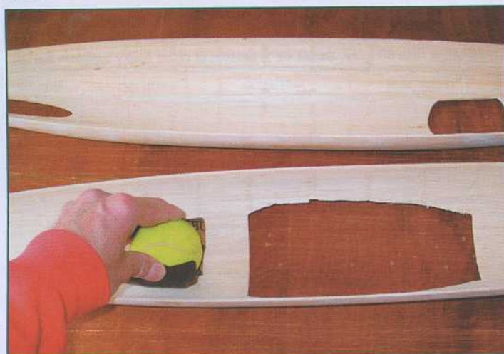
Les couples en Depron sont supprimés puis ponçage avec de la toile émeri sur une balle de tennis.
