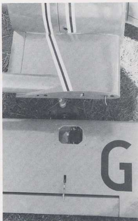
Les attaches de l'aile et le servo d'aileron.
