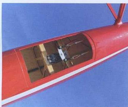
Le gouvernail est de belle facture, il est commandé par des câbles aller-retour en acier, reliés à un servo situé dans l'un des flotteurs en fibre de verre.
