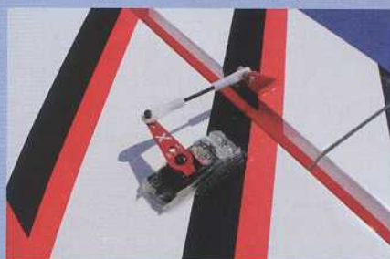
Les servos nécessitent des palonniers plus long, ici des Extreme Flight de 1,5 inches. Pour une utilisation en hydravion, les servos sont protégés par une couche de silicone.
