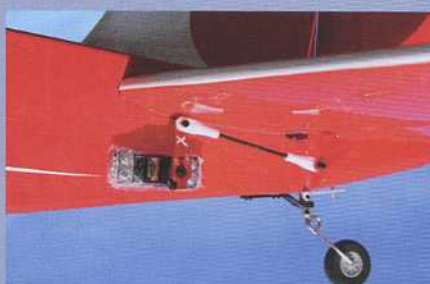
Les servos nécessitent des palonniers plus long, ici des Extreme Flight de 1,5 inches. Pour une utilisation en hydravion, les servos sont protégés par une couche de silicone.
