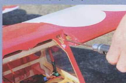
Le Muscle Coupe a une aile démontable en deux parties. Le verrouillage des panneaux se fait par deux vis situées à l'avant de la cabine, pratique !
