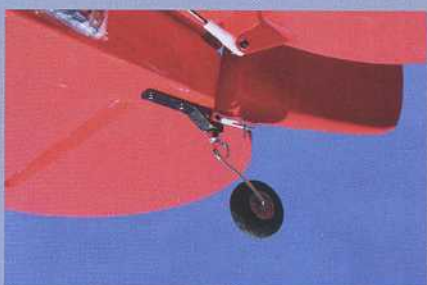
Le train principal et la roulette de queue sont en carbone. Les carénages de roues sont en fibre de verre et les habillages du train en balsa entoilé.
