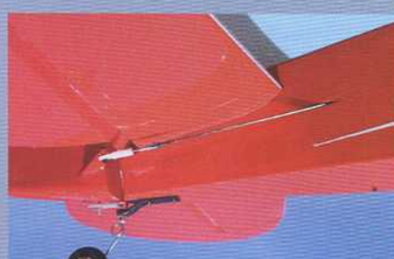
La commande de profondeur est prévue en CAP, mais l'auteur l'a remplacée par un jonc en carbone, insensible aux effets de l'eau et surtout plus léger. Notez les chapes à boule et les palonniers en plaque époxy.
