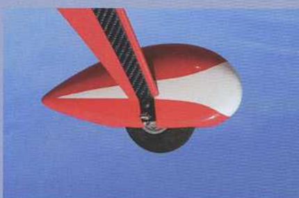
Le train principal et la roulette de queue sont en carbone. Les carénages de roues sont en fibre de verre et les habillages du train en balsa entoilé.
