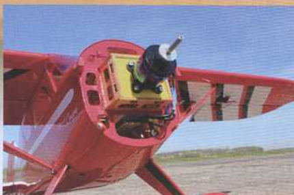
Le moteur Brushless OS est fixé par l'arrière et l'ESC est placé juste en dessous. Des mâts d'aile sont présents pour le look mais ne participent pas à la solidité de l'ensemble.
