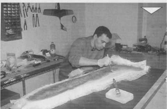
C'est reparti pour la stratification. Le même nombre de couche sera disposé sur chaque partie du moule.
