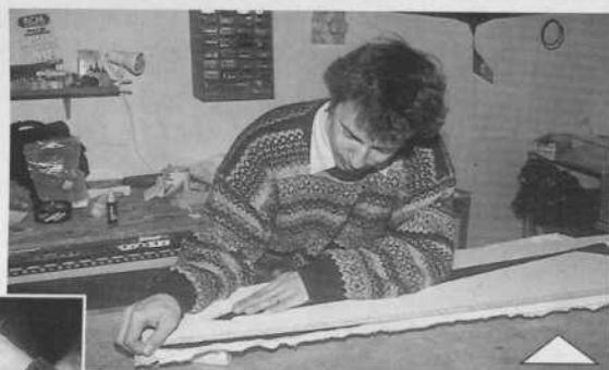
Démoulage. Si l'opération "cirage" a été effectuée correctement, tout se passe en douceur.
