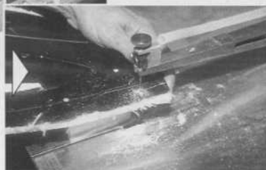
Ca y est. Le master sera ôté de l'autre demi-moule en tordant délicatement celui-ci.
