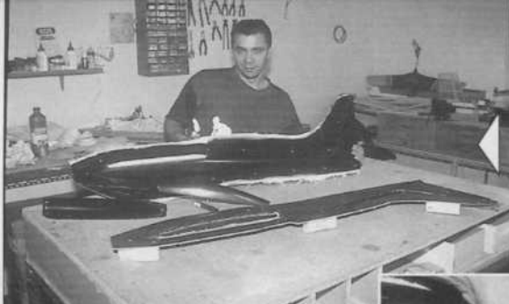
Ca y est. Le master sera ôté de l'autre demi-moule en tordant délicatement celui-ci.
