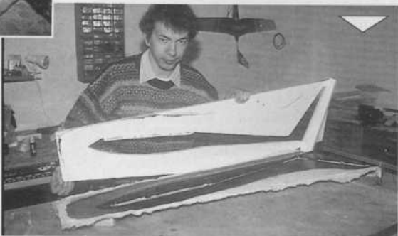
Démoulage. Si l'opération "cirage" a été effectuée correctement, tout se passe en douceur.
