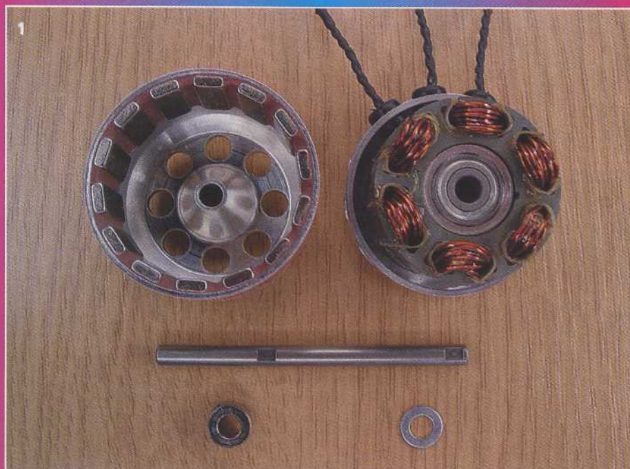
1 et 2) Le moteur démonté dévoile l'implantation des aimants sur le rotor et des bobinages sur la partie fixe. Appréciez le diamètre important de l'axe moteur. 3) L'axe moteur en place révèle le principe d'assemblage des Twister et du principe "LRK".
