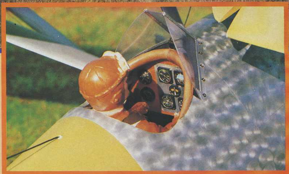
Ci-dessus, le MS 225 de profil dans la décoration des Avions de la Patrouille de Dijon. Ci-contre, le poste de pilotage et la finition alu bouchonné. Le pilote est du commerce, mais retravaillé au mastic.
