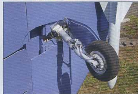
A l'intrados de chaque aile se trouve le servo d'élevon (un delta s'avère économique en servos), le faux armement, et une jambe du train rentrant.
