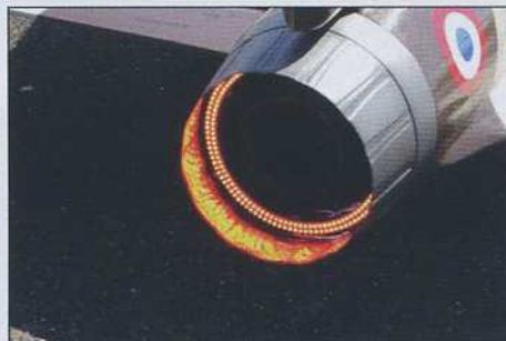
C'est un réacteur JetCat P160-SX qui motorise ce jet de 14,5 kg sans carburant. Pour ajouter au réalisme, un anneau de leds simulant la post-combustion a été placé en sortie de tuyère.
