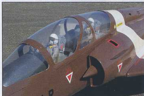
La longue verrière, biplace oblige, permet un accès aisé aux équipements situés à l'avant du fuselage. Mais cela suppose parallèlement la réalisation de deux postes de pilotage.
