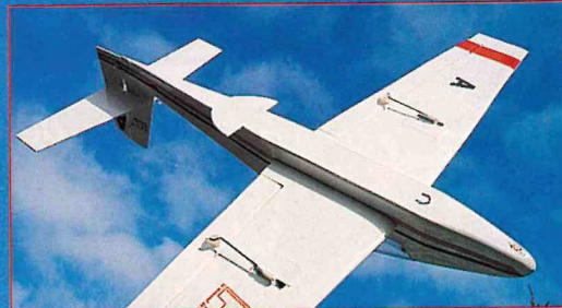
Vu d'ensemble du dessous : on voit les commandes d'ailerons, le crochet de catapultage et les moustaches de retenue.
