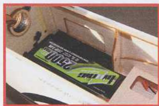
Au fond du fuselage à l'avant, le pack LiPo 2 S 2 500 mAh servira à alimenter la radio. Une platine support d'accu de propulsion vient le recouvrir et le verrouille.
