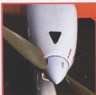
L'auteur a ouvert une ouïe sur le dessus du capot qui ventile directement le contrôleur.
