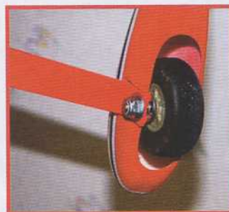
Fixation simple et efficace de la roue et du carénage sur le train principal.
