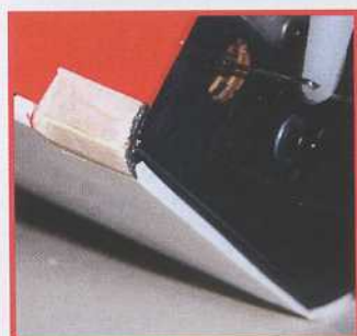
Une petite retouche du ponçage des angles inférieurs avant du fuselage a été nécessaire pour que le capot se monte correctement.
