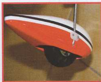
Un simple cavalier maintient le carénage avant, le montage manque de rigidité.
