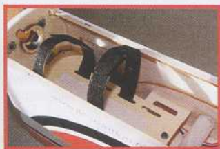
L'ensemble radio s'installe en arrière de la clé d'aile. Notez le régulateur de tension qui alimente la radio, et le servo supplémentaire dédié à la roulette avant.
