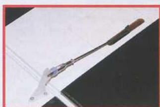
Une commande d'aileron, avec servo en attaque directe.
