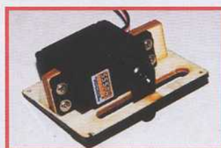
Les trappes de servos d'ailes sont déjà équipées des blocs de fixation.
