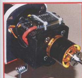
Le bâti pour moteur électrique peut supporter le contrôleur, et reçoit ici, à l'intérieur, le capteur de courant et tension. Plus on en met à l'avant, plus il est facile de centrer l'avion.
