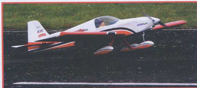
A l'atterrissage, on doit soigner l'arrondi et tenir l'avion nez haut afin de ne pas rebondir
