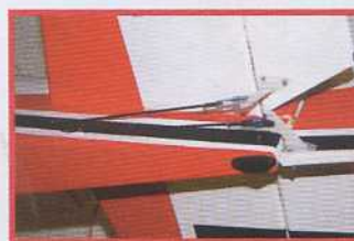
Les commandes de direction et de profondeur sortent du même côté du fuselage.
