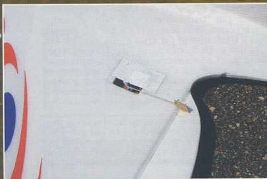
La commande d'aileron directe et l'articulation venant du moulage.
