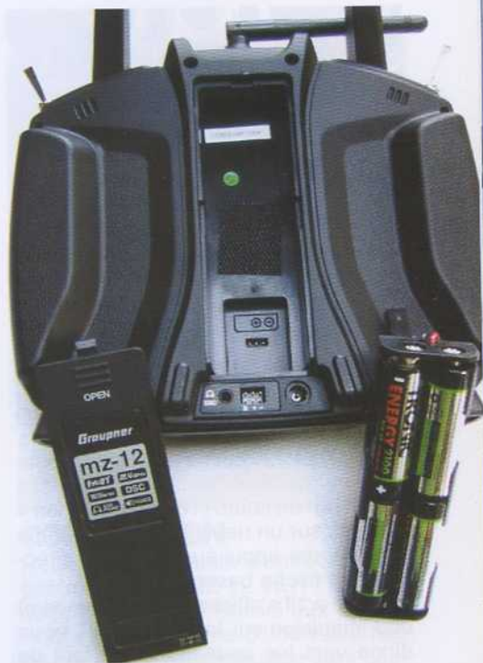
Le boîtier de la batterie (non fourni) est disposé verticalement, au-dessus prises jack male de 3,5 mm (casque audio/simulateur/écolage), PC/DATA (mises à jour du soft et smartbox) et prise de charge
