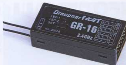
Le récepteur GR-16 8 voies dont la plage de tensions de fonctionnement va de 3,6 à 8,4 Volts fonctionne encore à 2,5 Volts. C'est sécurisant, mais les servos, eux, qui perdent de leur puissance en dessous de 4,8 Volts
