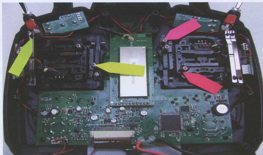
Les réglages de dureté des manches sur les deux axes (flèches rouges), de crantage ou rappel au neutre (flèches jaunes) sont faits facilement en serrant/desserrant quelques vis
