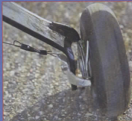
Trois vues du montage du frein équipant les roues du Léopard de René, un câble enroulé autour d'une poulie et tendu par un servo. Efficacité garantie.
