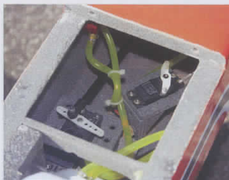
Une vue sur les servos de train avant et de gaz.
