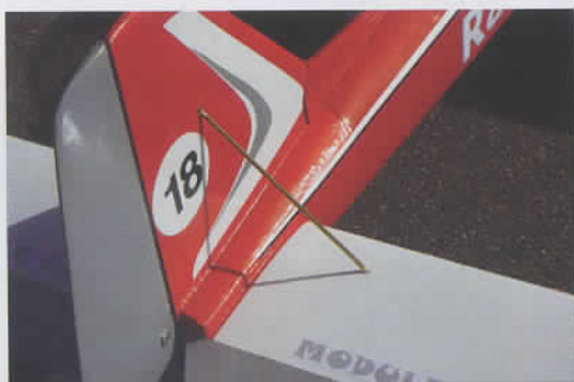
On peut ajouter ces petits haubans entre stab et dérive pour aider le câble à glisser en s'accrochant le moins possible.
