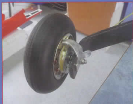
Trois vues du montage du frein équipant les roues du Léopard de René, un câble enroulé autour d'une poulie et tendu par un servo. Efficacité garantie.
