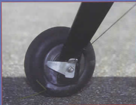
Trois vues du montage du frein équipant les roues du Léopard de René, un câble enroulé autour d'une poulie et tendu par un servo. Efficacité garantie.
