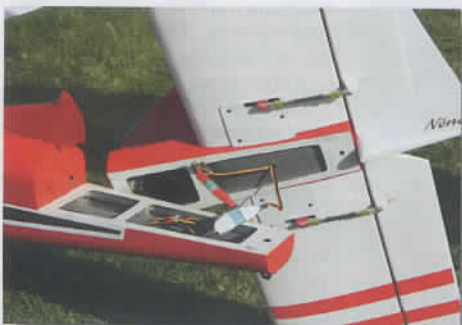
L'ensemble stab-dérive se démonte pour faciliter le transport.
