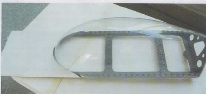
La bulle moulée est collée sur le capot d'accès à la radio et au réservoir.
