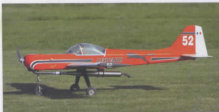
Haut perché sur son train, le Léopard permet de monter des hélices de fort diamètre sans crainte.
