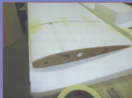
Deux vues de la préparation des noyaux avec la pose des nervures en contreplaqué qui supportent le fourreau de clé d'aile.
