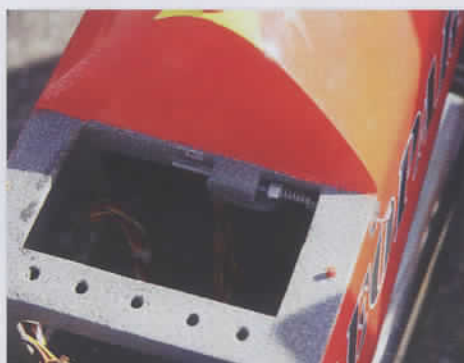
Le verrou de verrière à l'arrière de la cabine.
