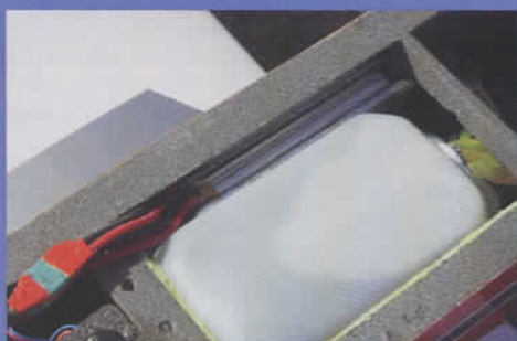
Les accus de réception Lipo sont logés dans les flancs.
