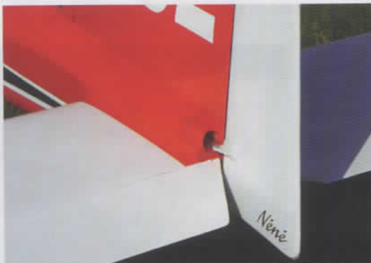
Une vue sur la commande de direction, bien protégée du câble de remorquage.
