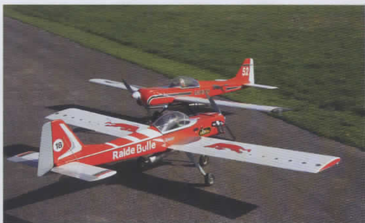
Une vue qui résume tout : aile avec de l'allongement, fuselage très long et stab de grande surface, tout pour que le vol soit super stable et très amorti, qualité plus qu'utile en remorquage.
