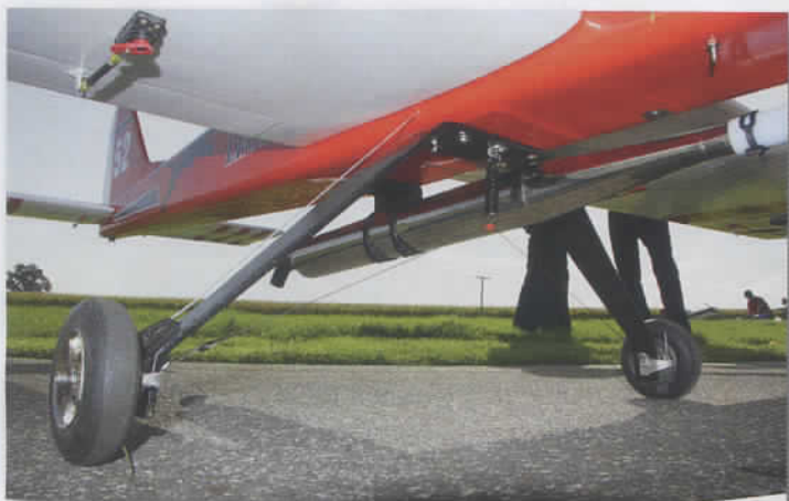
Une vue indiscrette sous l'avion, pour voir la fixation du train, le ressort de suspension additionnel. On voit aussi le passage des câbles des freins.
