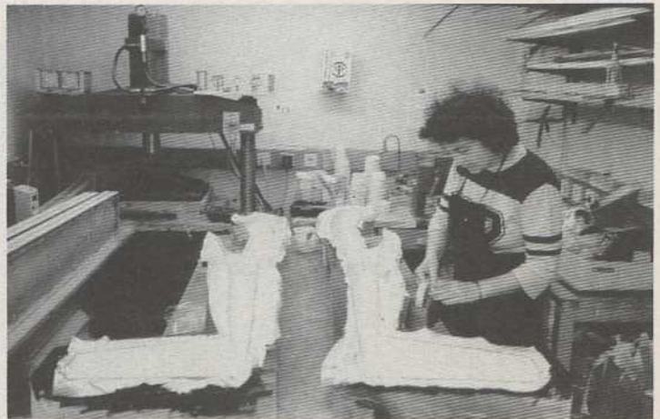
Moulage d'un fuselage de LS 4 par Jela Sommer.
