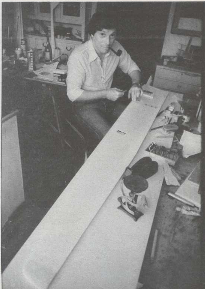
Un technicien de Rowing réparant une aile cassée. Mais oui, le tout plastique se répare sans problème !
