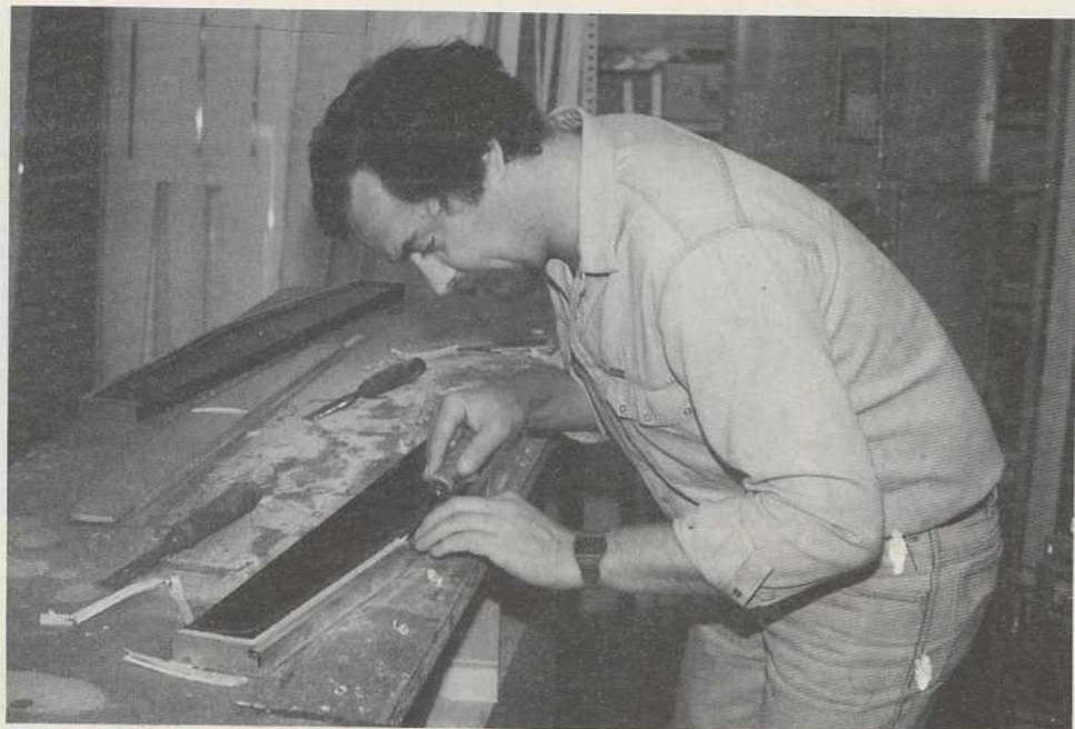
Roland Sommer nettoyant un moule d'où vient de sortir un stab.
