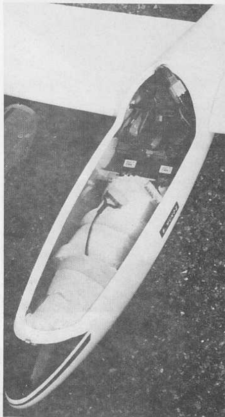
D'avant en arrière : accus 500 mAh, récepteur, servos de direction et de profondeur, prises servos d'ailerons.
