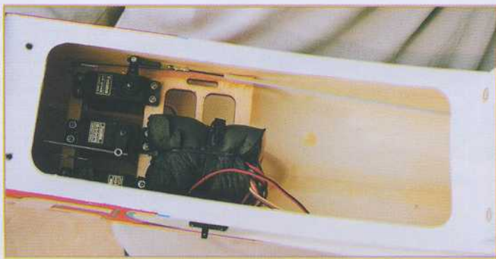
Pour obtenir un centrage sans plomb, l'auteur a reculé au maximum l'équipement radio.
