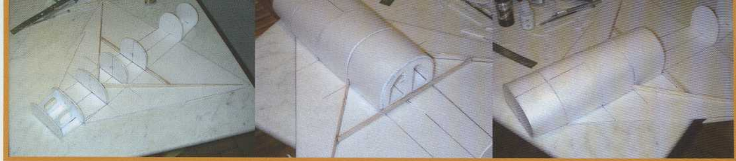
Le corps du Kfir : architecture Dépron® et longerons en balsa. Notez les cadres et coffrages en Dépron® de cette agréable structure mixte !
