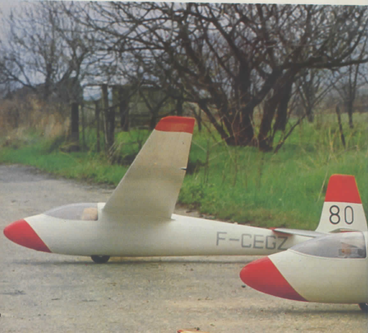
La dérive impressionnante permet des renversements comme vous n'en avez pas souvent en modèle réduit. Un patin évite au pied de la dérive de frotter par terre.
