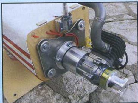
Le Titan 45 nous dévoile son montage. Le bâti est décalé pour que malgré l'anticouple, l'hélice soit dans l'axe du capot.
