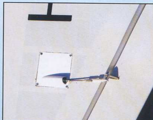
Les commandes d'ailerons avec les trappes servant de support servo.
