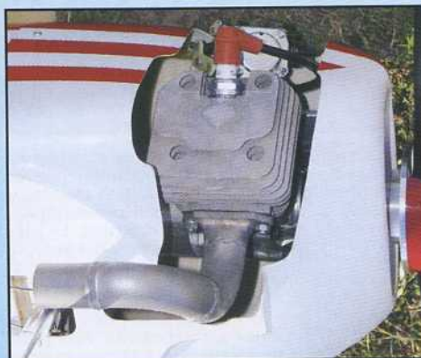
Le capot doit être largement entaillé pour le passage du Titan.
