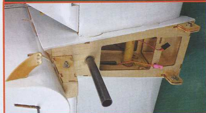
La dérive est démontable, ce qui est très pratique sur un aussi gros modèle. Elle est rigidifiée par un longeron carbone.
