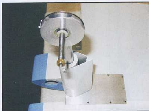
Une vue du train équipé de ses tôles de profilage et du disque de frein.
