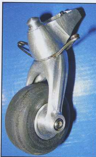
La roulette de queue... Taillée dans la masse, elle est exacte elle aussi.
