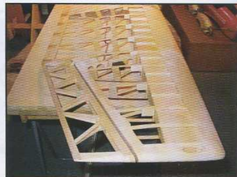
L'aile terminée avec son aileron. Le vrillage négatif typique des Jodel est donné par le longeron.
