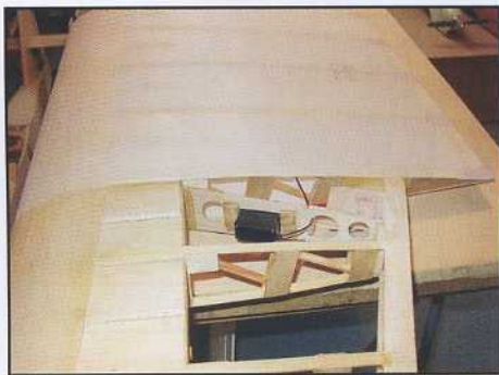
L'aile en cours d'entoilage. On voit le servo d'aileron déjà en place.
