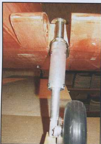
Le train en place, sans la tôle qui referme le bord d'attaque.
