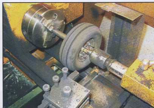
Tournage des pneus maquettes. Ils seront ensuite recouverts de Sikaflex lissé au doigt.
