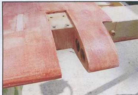
L'emplacement typique d'un train de Jodel sur l'aile. C'est le longeron qui supporte les efforts.
