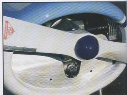
Une tôle canalise l'air sur le haut des cylindres.
