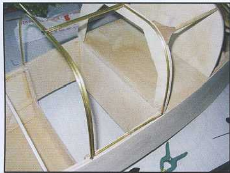
La future cabine, et l'on voit les tubes formant l'armature de la verrière.
