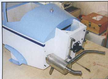
L'avant de la cellule avant la pose du moteur.
