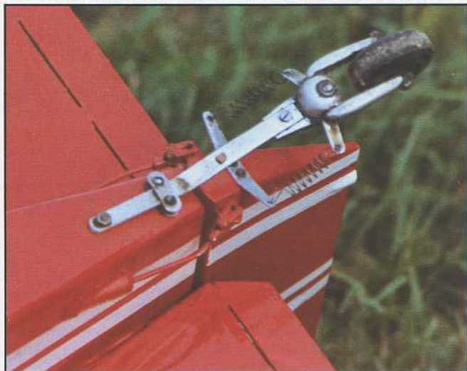
Détail de la roulette de queue, couplée à la direction.
