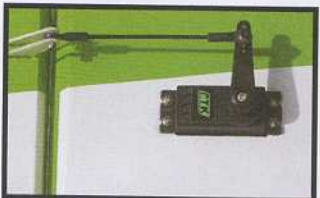
Une commande d'aileron. Noter le guignol double. Une vraie sécurité !
