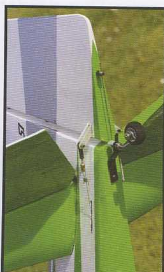
La dérive est commandée par un câble aller retour alors que la profondeur dispose d'un seul servo positionné à l'arrière. C'est suffisant vu la taille
