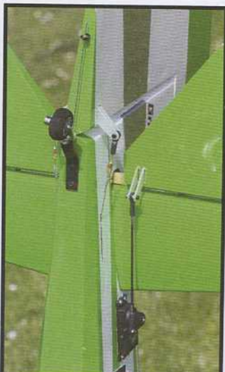
La dérive est commandée par un câble aller retour alors que la profondeur dispose d'un seul servo positionné à l'arrière. C'est suffisant vu la taille
