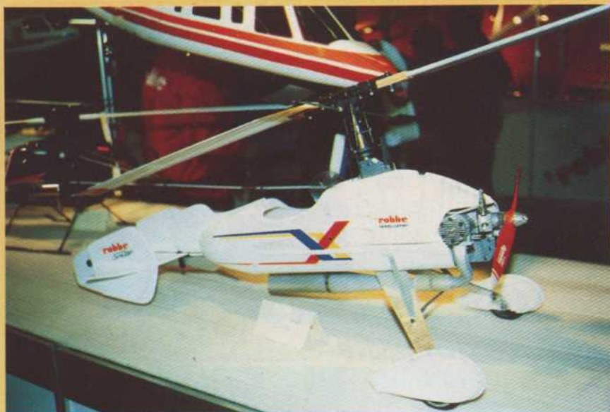
Fig. 4 : Quelques coaxiaux essayés il y a 16 ans. L'axe de traction du modèle RC est très haut pour éviter le cabré.
