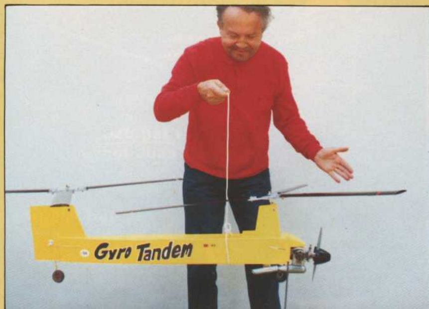
Fig. 7 : Une manière simple pour vérifier le centrage.
