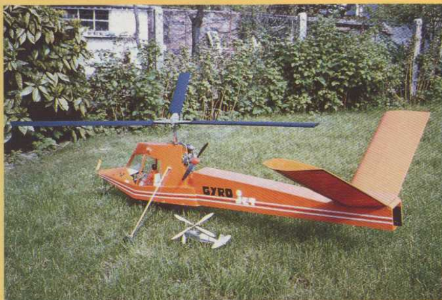
Fig. 5 : Autogyre à rotors latéraux de Skip Ruff, d'après l'hélicoptère allemand Focke-Wulf FA-61.
