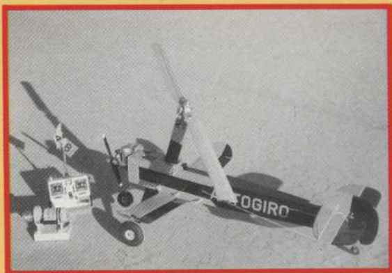
Fig. 1 : Le rotor en balancier assure une partie de la sustentation, mais non la stabilité qui provient des ailes.
