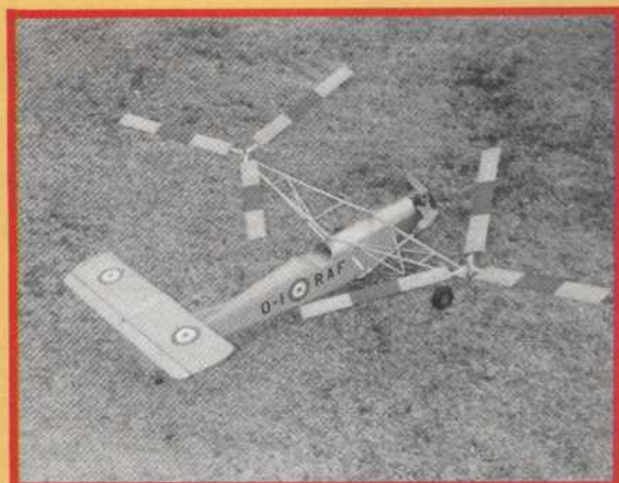
Fig. 5 : Autogyre à rotors latéraux de Skip Ruff, d'après l'hélicoptère allemand Focke-Wulf FA-61.
