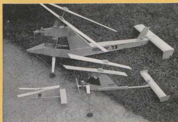
Fig. 4 : Quelques coaxiaux essayés il y a 16 ans. L'axe de traction du modèle RC est très haut pour éviter le cabré.
