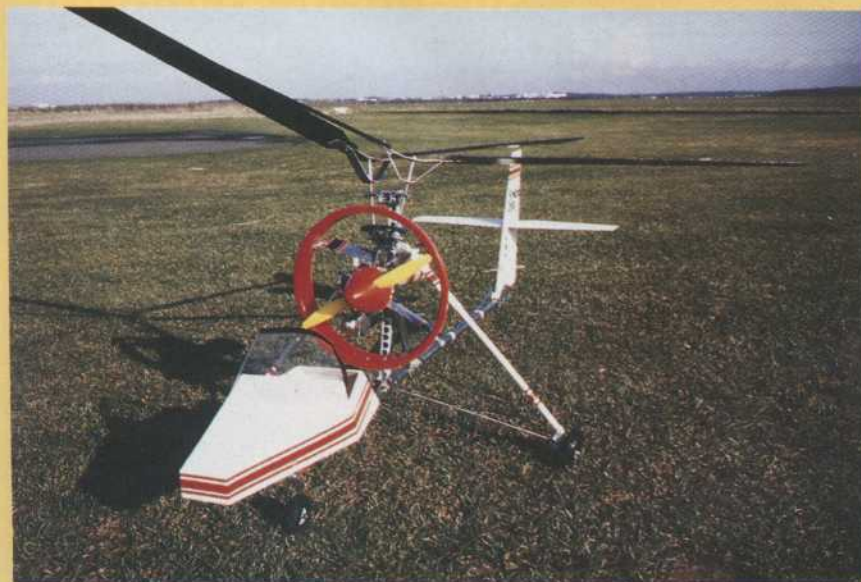
Fig. 6 : L'un des huit synchrogyres de Chaulet, à moteur 15 cc. Il n'y a que deux commandes, gaz et direction.
