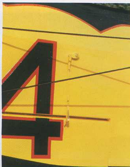
Une commande d'aileron très discrète.
