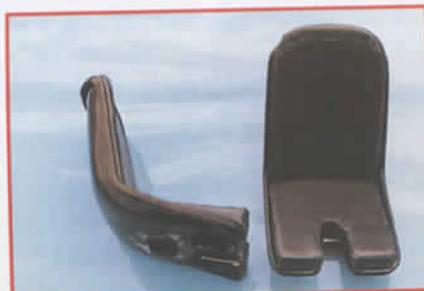
Les baquets des sièges sont réalisés en matériaux composites. Ci-dessous : la bulle est fixée sur son cadre par des vis M 1,6.
