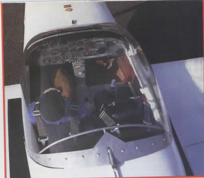
La bulle panoramique du RF-6B impose une réalisation soignée du tableau de bord et du cadre de verrière. Heureusement, l'échelle 1/4 facilite la réalisation de ces détails !
