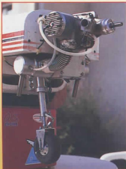
Le RF-6B échelle 1/4 peut recevoir plusieurs motorisations : ici un OS 90 FSR. Notez le carburateur monté en position inversée.
