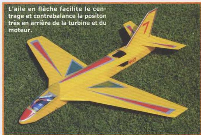
L'aile en flèche facilite le centrage et contrebalance la position très en arrière de la turbine et du moteur.
