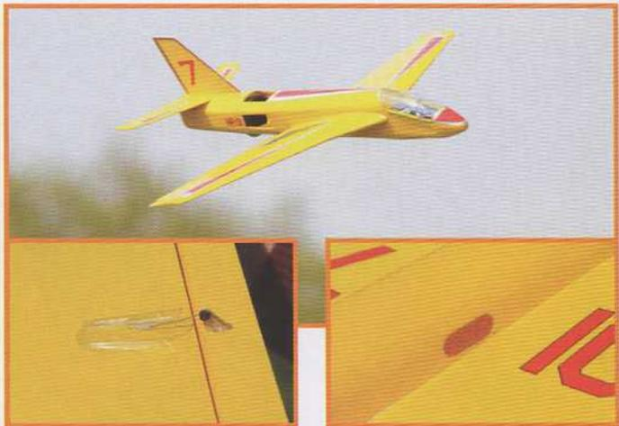
Protection de la commande d'aileron et papier de verre antidérapant.
