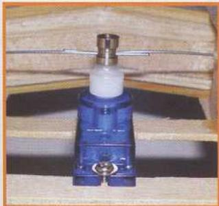
Servos d'ailerons et de profondeur au centre du fuselage.
